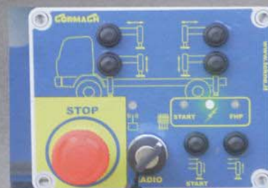
Comandi stabilizzatori elettrici Electric controls of the outriggers Commande stabilisateurs électriques Abstützungen elektronisch gesteuert (oder elektronisch überwacht?) Mandos para estabilizadores electricos
