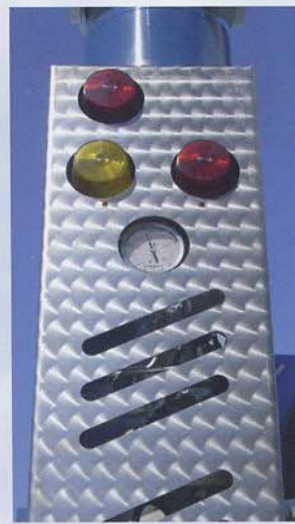
Manometro e flash indicatori dello stato di carico della gru Pressure gauge and flashing light indicating the load condition Indicateur de pression et signal lumineux, indiquant l'état de charge Manometer und optische Überlastanzeige Manometro e indicador de carga de la grúa
