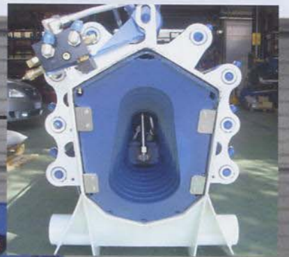
10 a e 11 a prolunga idraulica con cilindro interno 10 th and 11 th hydraulic extension with intern cylinder 10 ème et 11 ème extension hydraulique avec cylindre interne Die 10 und 11 hydraulische erlänge rung ist mit ein nternen Zylinder gesteuert Prolongar 10 y 11 hidraulica con cilindro interior
